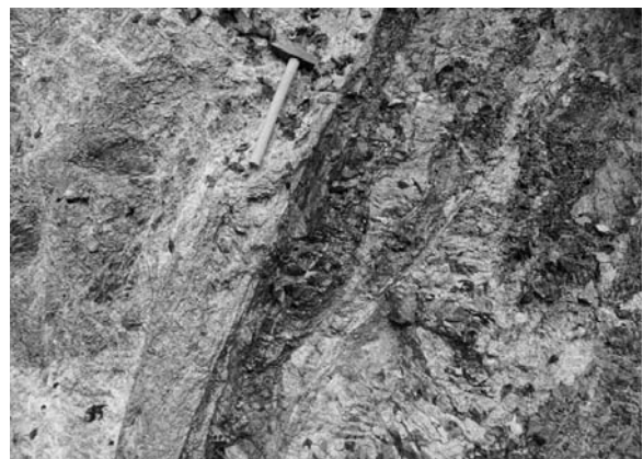
図3 破碎帯の接写 ハンマーの柄の長さ: 35 cm
