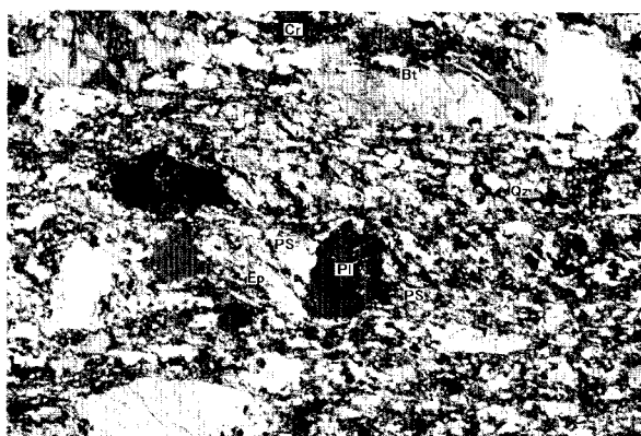
d: 同上 XZ 面, 偏光顕微鏡クロスポーラー, 横幅 3.15mm Bt 黒雲母, Cr 緑泥石, Ep 緑簾石, Pl 斜長石, Qz 石英, PS プレッシャー・シャドウ
