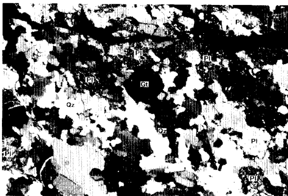
e: 同上 XZ 研磨面, 偏光顕微鏡クロスポーラー, 横幅 3.15mm Gt ざくろ石, Bt 黒雲母, Pl 斜長石, Qz 石英
