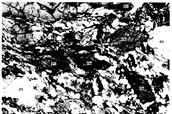
d : No.03122216, No.8+2 露頭 (MTLから 720m) 角閃石黒雲母トーナル岩源プロトマイロナイト XZ面, 偏光顕微鏡クロスポーラー, 横幅 3.15mm Hb 角閃石, Bt 黒雲母, Pl 斜長石, Qz 石英
