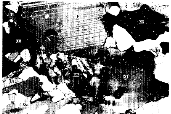
b: 同左 (ミルメカイト形成部分) XZ面, 偏光顕微鏡クロスポーラー, 横幅 1.26mm Bt 黒雲母, Pl 斜長石, Kf カリ長石, Qz 石英, Mk ミルメカイト
