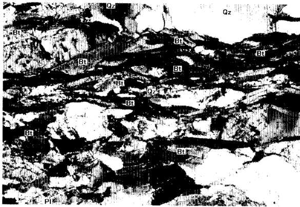
a: No.0312206, No.13-3 露頭 (MTLから 1350m) マイロニティック細粒片麻状角閃黒雲母トータル岩 XZ面, 偏光顕微鏡クロスポーラー, 横幅 3.15mm Bt 黒雲母, Pl 斜長石, Qz 石英
