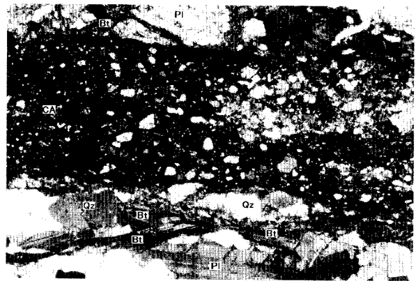
b: No.03122205-01, No.13-2 露頭 (MTLから 1410m) マイロニティック・トータル岩中の後生的脆性小剪断帯 XZ面, 偏光顕微鏡クロスポーラー, 横幅 3.15mm CA 脆性剪断帯, Bt 黒雲母, Pl 斜長石, Qz 石英
