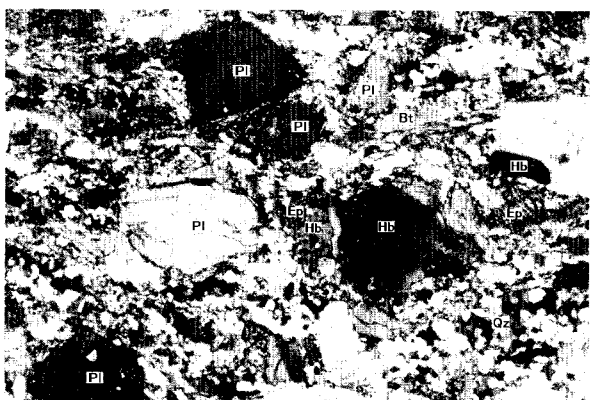
f : 同左 XZ面, 偏光顕微鏡クロスポーラー, 横幅 3.15mm Hb 角閃石, Pl 斜長石, Bt 黒雲母, Qz 石英, Ep 緑緑石
