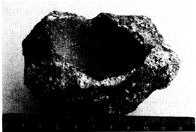
図12 球顆の脱落痕を持つKA-02 内壁は黒雲母でコーティングされ、滑らかである。
