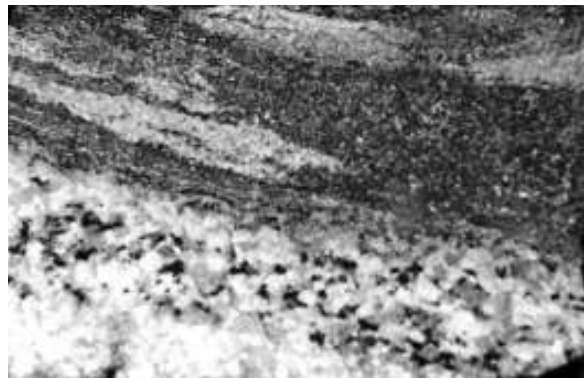
図 7 生田花崗岩 (下側) と変成岩捕獲岩 (上側) の境界付近のサンプル。面構造が顕著に現れている。
